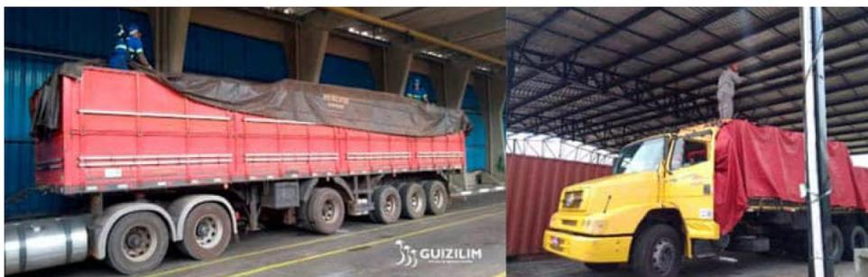
Figura 4-11 Exemplos de Enlonamento e Reenlonamento de Caminhões
