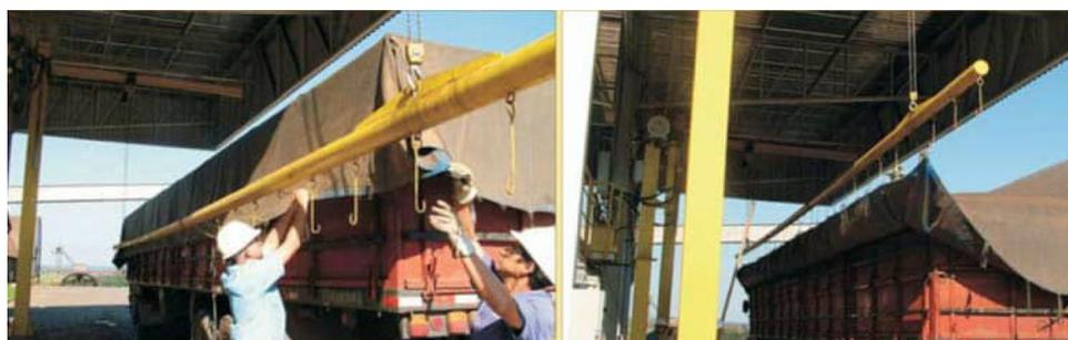
Figura 4-10 Exemplos de Enlonamento e Reenlonamento de Caminhões
