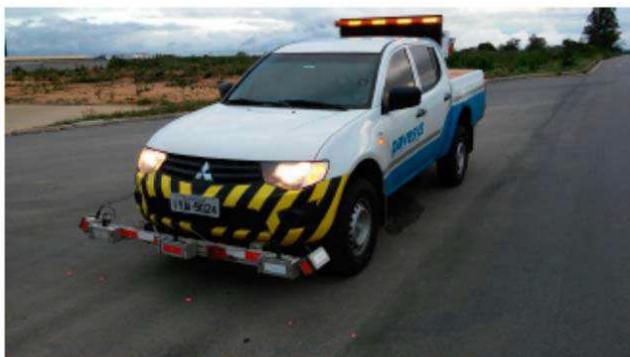
Figura 2-9 Perfilômetro laser
