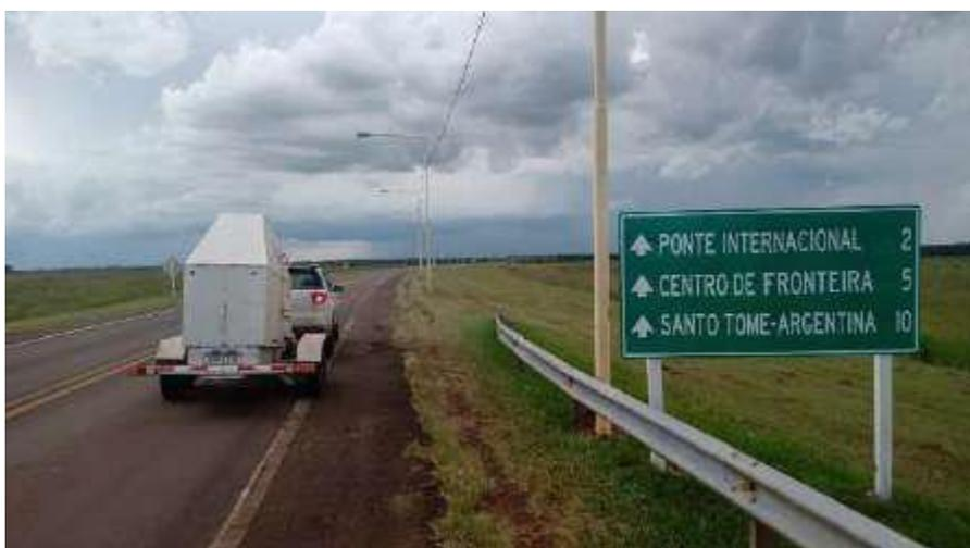
Figura 2-7 Imagem do equipamento FWD em uso
