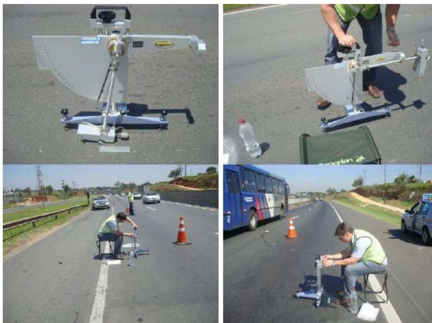
Figure 1 Método do pêndulo Britânico
