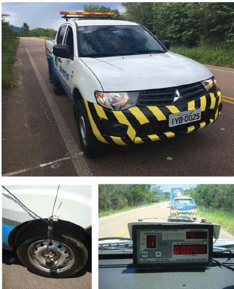
Figura 2-10 Automóvel equipado para o LVC - DNIT - PRO 008/2003
