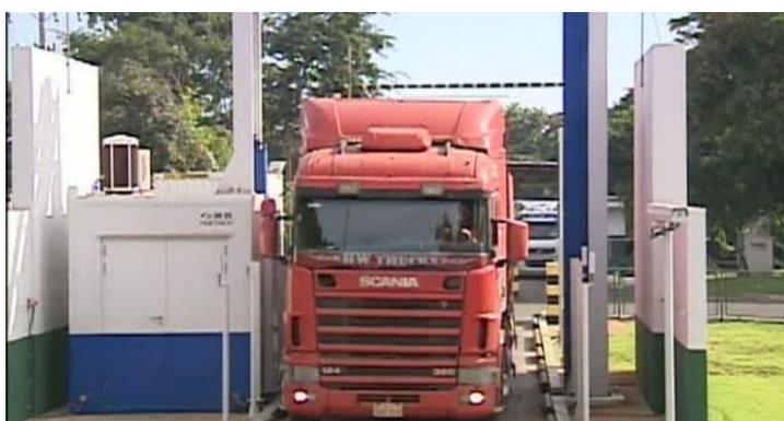
Figura 5-5 Exemplo de scanner fixo (raio X) para caminhões
